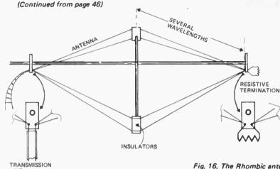
Fig. 16. The Rhombic antenna.
